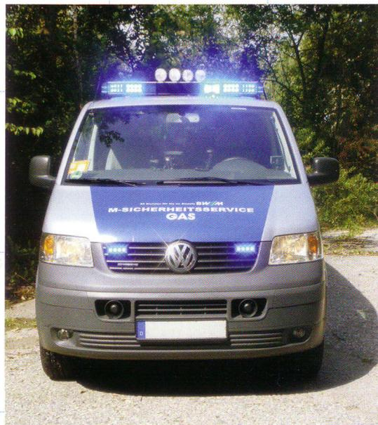
Fahrzeug mit LED-Balkenanlage, abgesetzter Sondersignalanlage und LED-Frontblitzern Sputnik nano (2008)
