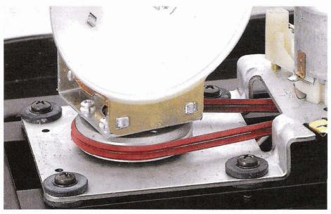
Der robuste Doppelriemenantrieb ist Garant für eine hohe Funktionsfähigkeit und lange Lebensdauer. Selbst bei Ausfall eines Keilriemens ist die Kennleuchte noch voll funktionsfähig. Der Antrieb ist nach VDE 0879,Teil 3, funkentstört (Funkstörgrad 5), und beeinträchtigt damit weder den Funkbetrieb noch den Radioempfang.
