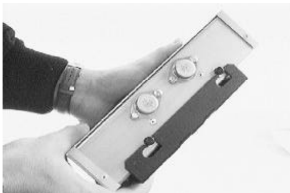
Abb. 9: Entfernen des verstärkers aus dessen unterteil (nach unten drücken und nach vorn schieben)
