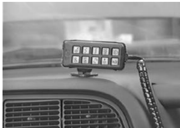
Abb 2: Horizontaler einbau am fahrzeug-armaturenbrett.
