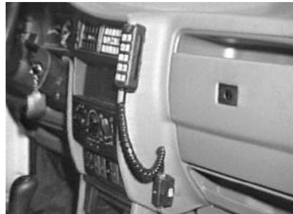
Abb 8: Ansicht des steuerelements, in dessen unterteil und angeschlossen an anschlußbox.
